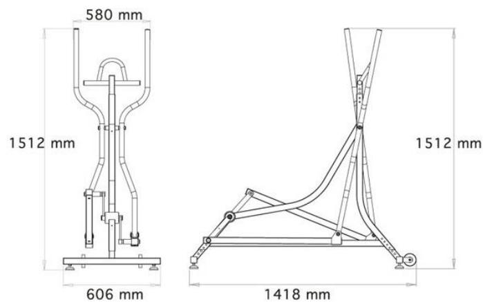
**BICICLETA ELIPTICA ACUATICA** CONSTRUCCIÓN REFORZADA PARA USO INTENSIVO O PROFESIONAL EN ACERO INOXIDABLE CON TRATAMIENTO ELECTRO PULIDO DE PROTECCIÓN. RODAMIENTOS ESTANCOS INOX DE GRAN DIÁMETRO EN EL PEDALIER CENTRAL, UNICO SISTEMA QUE GARANTIZAN GIRO PERFECTO. PEDAL REGULABLE SEGUN TALLA DE PIE RECUBIERTO EN EVA FUNGICIDA DE GRAN COMODIDAD PARA SU USO CON LOS PIES DESCALZOS. MEDIDAS INDICADAS EN MM.
